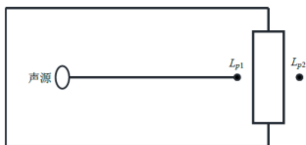
图 4-2 室内声源等效为室外声源图例
