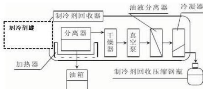
图 2-3 制冷剂回收装置工作流程示意图
